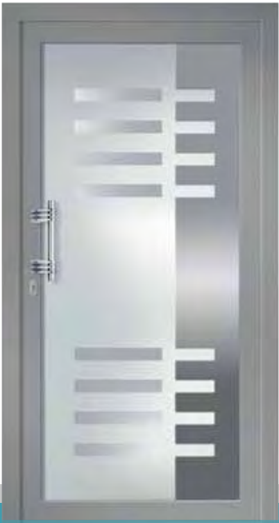
G 472/G empf. Türmindestmaß 980 x 1850 mm Ganzglasfüllung 3-fach Glas Ug 1,7 bei 28 mm und Ug 1,1 bei 36 mm helle Flächen mattiert, dunkle Streifen Klarglas, kammartige Applikation ■ Griff ZAE 134 | PG 11
