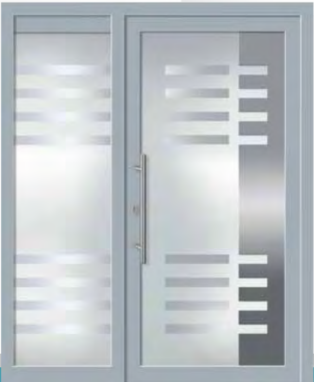
G 472/G empf. Türmindestmaß 980 x 1850 mm Ganzglasfüllung 3-fach Glas Ug 1,7 bei 28 mm und Ug 1,1 bei 36 mm helle Flächen mattiert, dunkle Streifen Klarglas, kammartige Applikation ■ Griff ZAE 6s 600 mm | PG 6 ■ Seitenteil Sandstrahlglas ST 472/G
